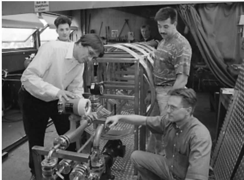
Letzte Vorbereitungen vor dem Start zur Achema 97 in Frankfurt: Prof. Dr. Gerhard Geiger (vorne links) und sein Team legen letzte Hand an das Modell eines Lecküberwachungssystems für Pipelines. Vorn sieht man eine Meßstation, im Hintergrund 200 Meter gewickeltes Kupferrohr, das die Pipeline simuliert. Foto: FHG/HT
