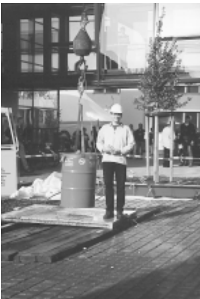
Materialtechnikstudent Neil Jaschinski (23) beaufsichtigte die Fallversuche mit Wassertonnen, bei der die Dichtigkeit der Stahltonnen nach dem Aufprall geprüft wurde.
