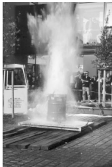
Unsanft gelandet: Aus zwölf Metern Höhe kracht eine Stahltonne gefüllt mit Wasser auf eine Platte aus Stahl. Der Wasserdampf (Foto links) entsteht während des Falls und unmittelbar nach der Landung. Die dicken Tropfen (Foto rechts) bilden sich kurz darauf. Hier ist die Stahlplatte von dem Aufprall bereits wie eine Feder zusammen gedrückt, was man an dem nun nicht mehr vorhandenen Zwischenraum zwischen den Platten erkennt. Fotos: FHG/BL
