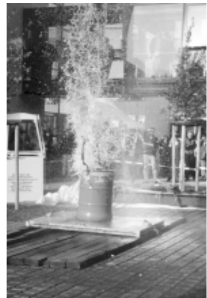
Unsanft gelandet: Aus zwölf Metern Höhe kracht eine Stahltonne gefüllt mit Wasser auf eine Platte aus Stahl. Der Wasserdampf (Foto links) entsteht während des Falls und unmittelbar nach der Landung. Die dicken Tropfen (Foto rechts) bilden sich kurz darauf. Hier ist die Stahlplatte von dem Aufprall bereits wie eine Feder zusammen gedrückt, was man an dem nun nicht mehr vorhandenen Zwischenraum zwischen den Platten erkennt. Fotos: FHG/BL
