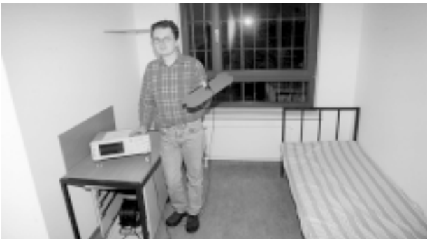
Aus der Gefängniszelle sendete Hochschulmitarbeiter Dirk Warmbier Musterwellen, die im Gefängnishof vom Messzelt aus aufgezeichnet wurden und dazu dienen, in Zukunft unerlaubtes Mobil-Telefonieren aus dem Gefängnis zu unterbinden.
