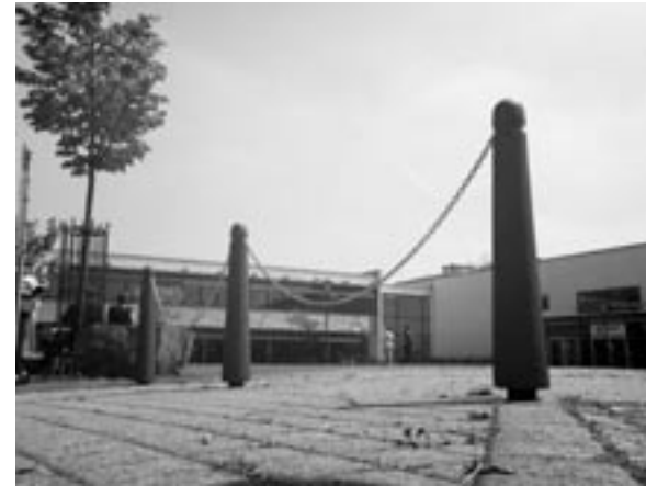
Graue Poller und Ketten können im November-Zwielicht leicht einen Sturz auslösen. Hier könnte eine Farbmarkierung helfen. Foto: FHG/HT
