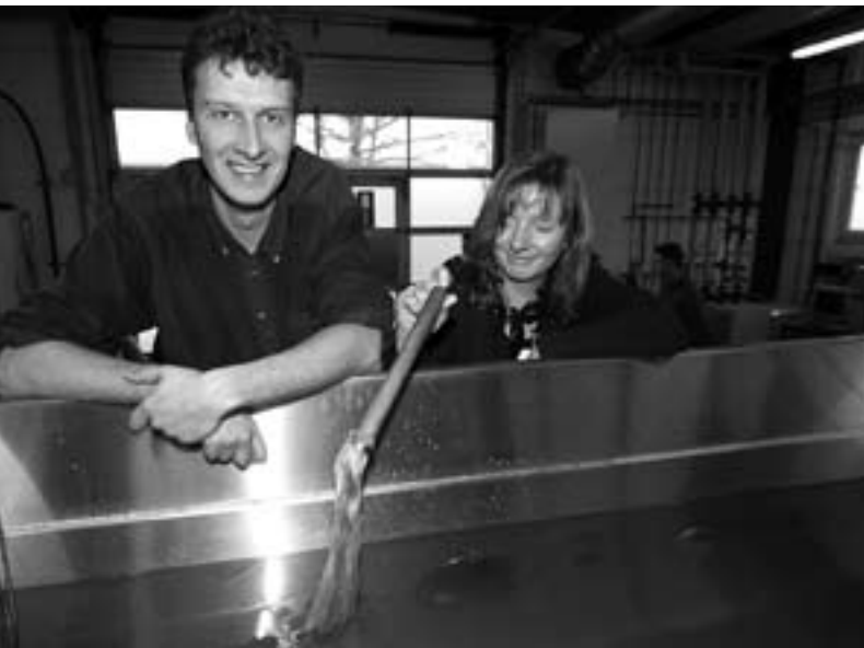
▲ Mit einem DIN-gerechten Prüfinstrument, das nur für Laien wie ein Wischmopp mit Haaren aussieht, konnten die Seminarteilnehmer in der Praxis lernen, wie sie in Bädern die mögliche Ansauggefahr in Badebeckenöffnungen prüfen. Foto: FHG/BL
