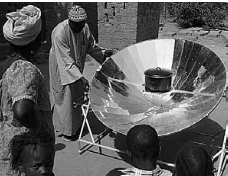
▲ Im Brennpunkt des Parabolspiegels kocht das Essen. Die gambische Musterfamilie von Ebrima Camara hatte schnell die Vorteile des Kochens mit Solarenergie heraus. Foto: T. Nierhoff
