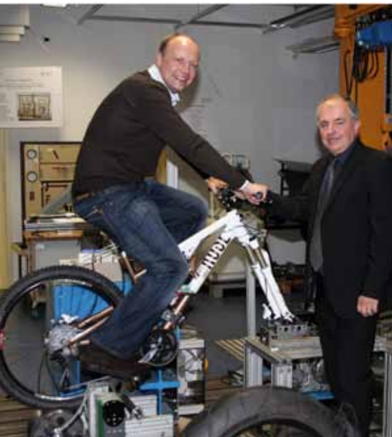
Zur Entwicklung eines E-Bikes haben der Bocholter Fahrradbauer Rose (im Bild links Thorsten Heckrath-Rose) und das Mechatronik-Team von Prof. Dr. Antonio Nisch (r.) an der Hochschulabteilung Bocholt einen Fahrradprüfstand aufgebaut, der mit und ohne Radler das neue Bike testet.
