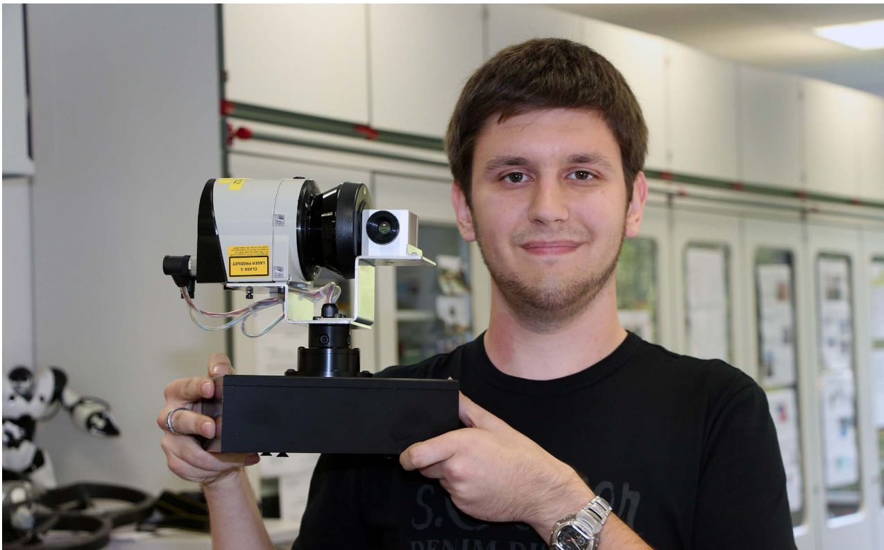
Tom-Marvin Liebelt hat für seine Bachelor-Arbeit in angewandter Informatik einen rotierenden Laser-Scanner (l.) mit einer Wärmebildkamera (das weiße Kästchen) verheiratet. Foto: WH/BL
