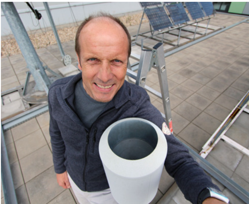
Der Topf ist leer, aber nicht, weil es nicht geregnet hat. In den automatischen Wettermessstationen der Westfälischen Hochschule wird der Niederschlag nicht in Messbechern aufgefangen, sondern seine Menge wird, so erläutert Thomas Nierhoff, im Durchlaufverfahren über eine Kipp-Waage gemessen. Foto: WH/BL
