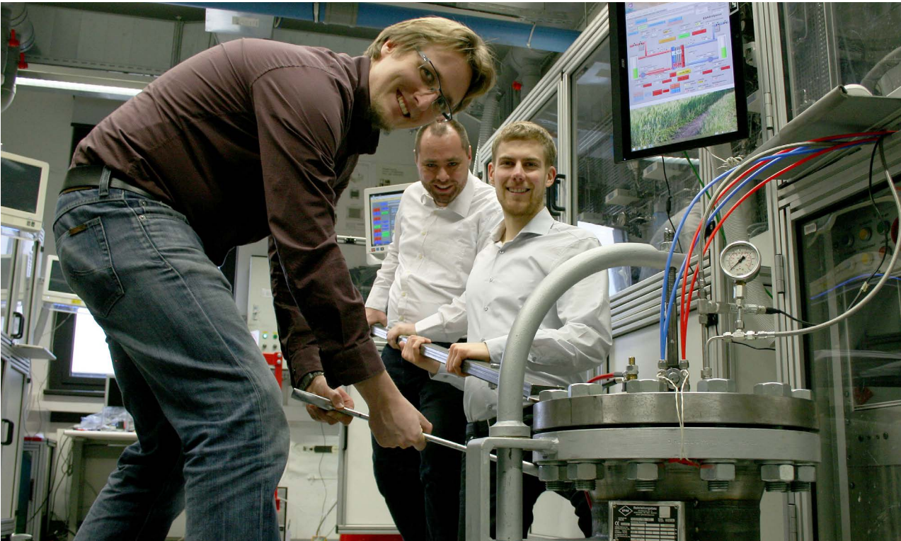
Die Mitarbeiter am Westfälischen Energieinstitut (v.l.n.r.) Dr. Ulrich Rost, Jeffrey Roth und Pit Podleschny demonstrieren mit verlängerten Maulschlüsseln, wie fest die Schrauben und Muttern am Hochdruck-Elektrolyseur-Prototyp (rechts unten) angezogen werden müssen, damit im Innern ein Betriebsdruck von über 50 Bar sicher aufgebaut werden kann. Mit dem Elektrolyseur kann der zuvor aufgesplante Wasserstoff direkt ins Erdgasnetz – das auch unter diesem Druck betrieben wird – eingespeist werden. Foto: WH/MV
