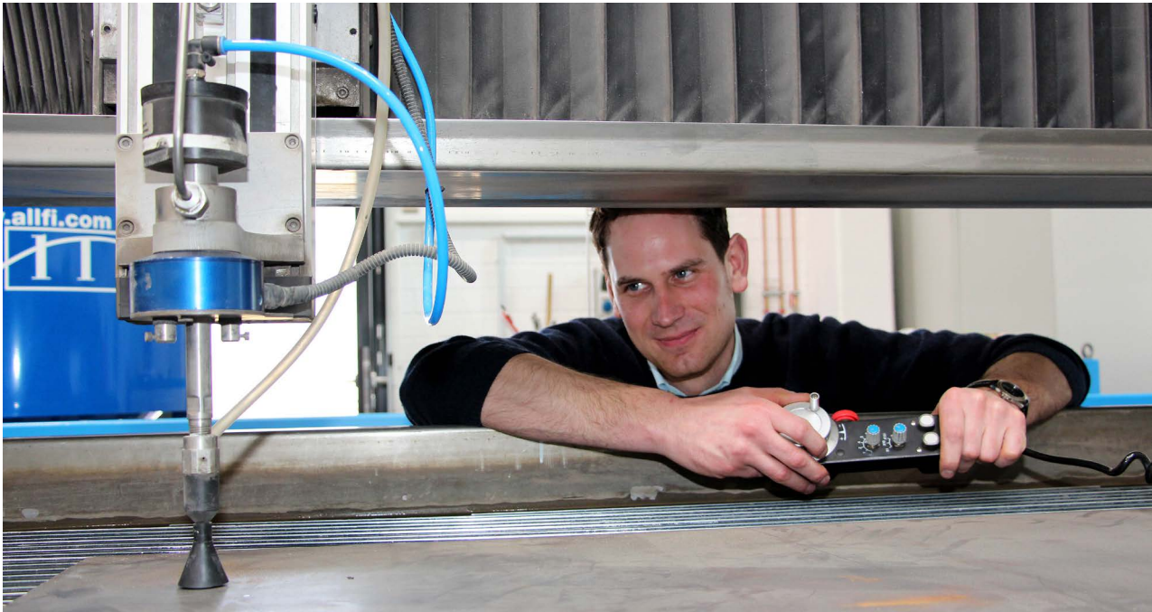
Bernd Hegerfeld, wissenschaftlicher Mitarbeiter im Bocholter Fachbereich Maschinenbau, half beim Aufbau einer Wasserstrahlchneidanlage. Sie wird auch im neuen Masterstudiengang „Business Engineering“ zu Zwecken von Lehre und Forschung eingesetzt und ist in der Praxis Teil der Fertigungstechnik im Leichtbau, wenn sie Bauteile aus Aluminium, faserverstärkten Kunststoffen oder Sandwichstrukturen aus verschiedenen Materialien schneidet. Finanziert wurde ihre Anschaffung über das NRW-Förderprogramm „FH Basis“. Foto: WH/BL
