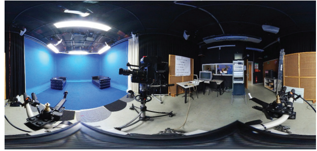
Beim Dreh des 360-Grad-Videos werden zwei 180-Grad-Bilder zusammengerechnet. Als Beispiel ist hier die Abwicklung der beiden Bilder im TV-Studio zu sehen und damit eines der Bühnenbilder, für die die Studierenden die Inszenierung geschrieben haben. Foto: Kirill Kronhardt
