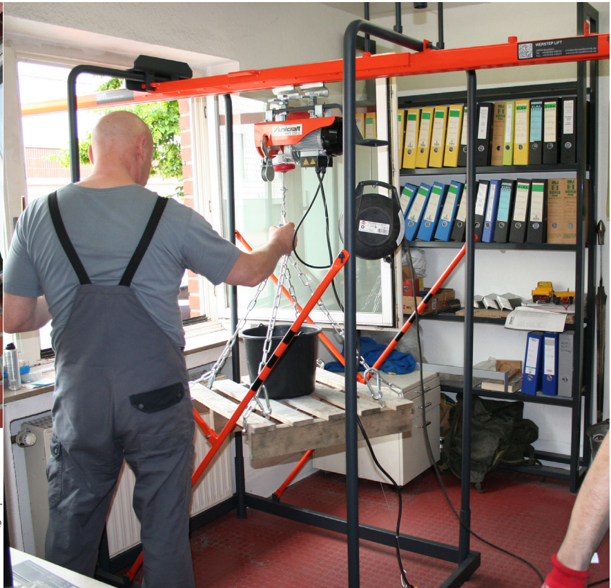
Die neue Hubvorrichtung der Firma „Profi Metall & Technik GmbH“ in Stadtlohn holt Lasten bis zu 125 Kilogramm an der Fassade in obere Stockwerke und holt sie über eine Laufkatze ins Gebäudeinnere. Die mobile Hubvorrichtung wird am Wunschort aus Einzelteilen ohne Werkzeug zusammengebaut. Im Mechatronik-Institut der Westfälischen Hochschule in Bocholt wurde sie für das europäische CE-Zeichen als Nachweis geltender Anforderungen auf potenzielle Schwachstellen geprüft. Fotos: Profi Metall & Technik
