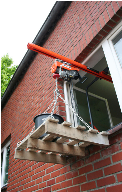
Die neue Hubvorrichtung der Firma „Profi Metall & Technik GmbH“ in Stadtlohn holt Lasten bis zu 125 Kilogramm an der Fassade in obere Stockwerke und holt sie über eine Laufkatze ins Gebäudeinnere. Die mobile Hubvorrichtung wird am Wunschort aus Einzelteilen ohne Werkzeug zusammengebaut. Im Mechatronik-Institut der Westfälischen Hochschule in Bocholt wurde sie für das europäische CE-Zeichen als Nachweis geltender Anforderungen auf potenzielle Schwachstellen geprüft. Fotos: Profi Metall & Technik
