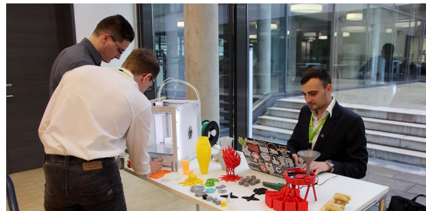
Philipp Kröll (l.), Arthur Gawenda (2.v.l.) und Deian Ardeljan (r.) vom Labor für additive Fertigung des Maschinenbau-Instituts der Westfälischen Hochschule zeigten Produkte aus dem 3-D-Drucker, hier aus Polylactiden. Das Labor verfügt aber auch über 3-D-Drucker, die mit Nylon oder Metallen arbeiten. Diese Drucker werden vor allem für Produkte genutzt, die auf herkömmliche Weise nur in Bauteilen gefertigt werden können und dann montiert werden müssen. Der 3-D-Drucker kann es in einem Arbeitsschritt. Foto: WH/BL
