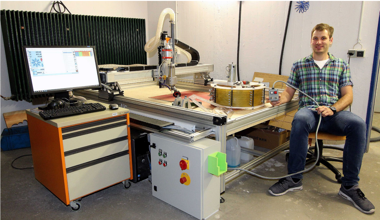
Florian Zellmer hat eine CNC-Fräse gebaut, die in allen drei Raumrichtungen arbeitet. Mit ihr hat er als Masteraufgabe den sechsphasigen Trommelbeschleuniger gebaut, der zusammen mit anderen Werkstücken hier auf der Fräse zu sehen ist. In der Hand hält Zellmer die Fernbedienung für die Fräse, die er zusätzlich zur Rechnersteuerung angebaut hat. Foto: WH/BL
