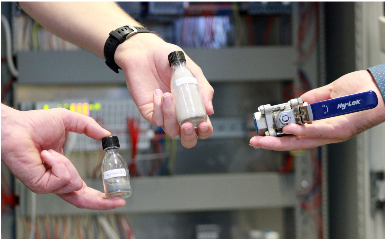
Wasserstoff (symbolisch der Ventilhebel r.), Metallhydrid (das helle Pulver in der Kunststoffflasche, Mitte) und Magnesiumpulver (das graue Pulver in der Kunststoffflasche l.) sind die Zutaten für einen innovativen Wärmeverrat in Metallhydridspeichern. Dabei wird der Wasserstoff in einem Metall oder einer Metalllegierung gelöst gespeichert. Um den Wasserstoff als Reagenz wieder auszutreiben, reichen Druckminderung und leichte Wärmezufuhr. Im Hintergrund ist eine zentrale Steuereinheit bereits für das Projekt vom Team aufgebaut worden. Foto: WH/MV
