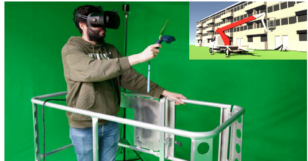
Eine Greenscreen-Box mit der Arbeitsbühne sowie ein Headset für die Mixed-Reality-Umgebung simulieren die Bedienung mit einem Steiger und sorgen für hohe Realitätsnähe. Das Bild oben zeigt die Simulationsumgebung. Foto: WH
