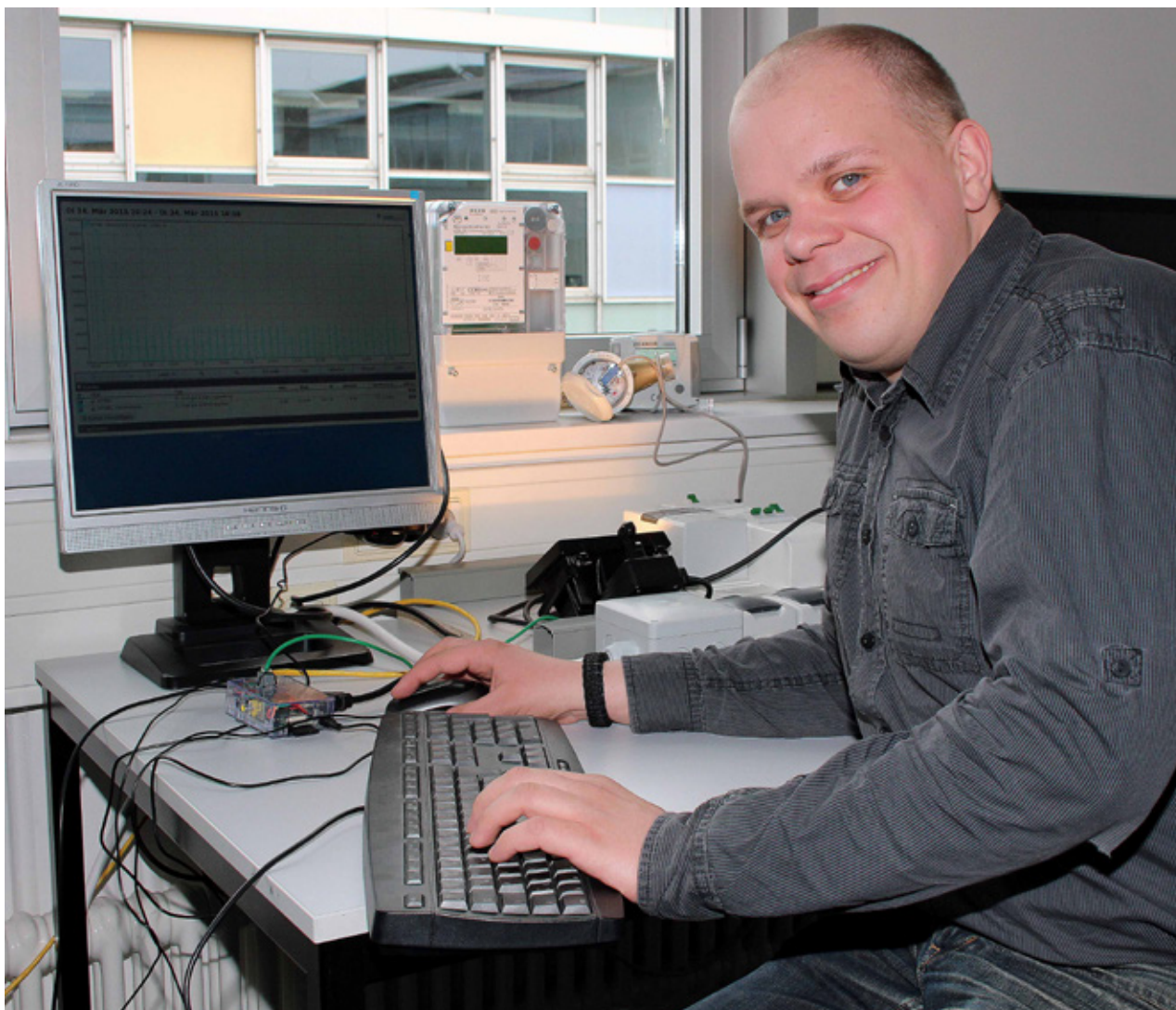
Maximilian Pascher zeigt, wie's geht: Strom- und Wasserzähler (im Hintergrund auf der Fensterbank) liefern die Daten, die von einer besonderen Technikschnittstelle (in dem kleinen transparenten Kästchen vor dem Bildschirm) an den Auswertungscomputer gehen, der dann daraus statistische Verbrauchsmuster berechnet. Foto: WH/BL
